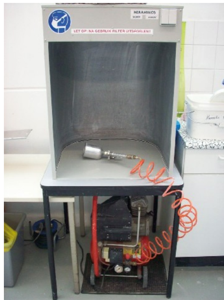
Spuitkabine met afzuiging, compressor en glazuurspuit:
